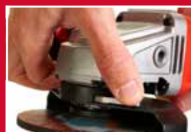
Justering af beskyttelseskærm uden brug af værktøj
