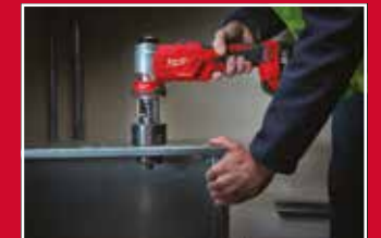
HUL - bare tryk på aftryderen og hullet laves
