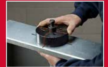
SÆT OP - Juster matricen så det passer med hvor hullet skal være
