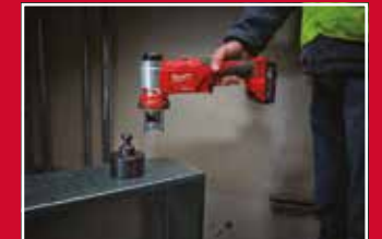
FORBIND - Tag værktøjet og forbind det til matricen
