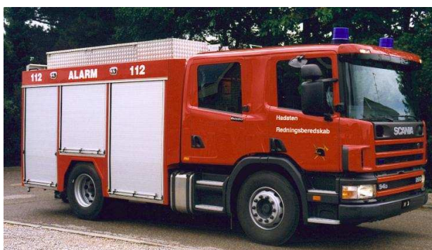
Automobilsprøjte opbygget på Scania P 94 chassis med originalt Scania mandskabskabine. Leveret i 1999 til Hadsten Brandvæsen
