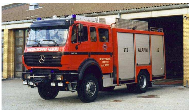
Automobilsprøjte opbygget på Mercedes-Benz 1831/4 x 4 chassis leveret i 1996 til Beredskabscenter Aalborg
