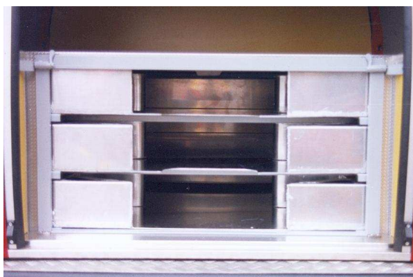
Ramme med 3 alum. slangebakker placeres i bunden af varerummet
