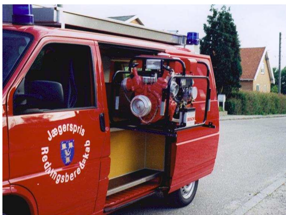
Slangetender med ZIEGLER TS 8/8-1 bærbar motorsprøjte leveret i 1996 til Jægerspris Brandvæsen
